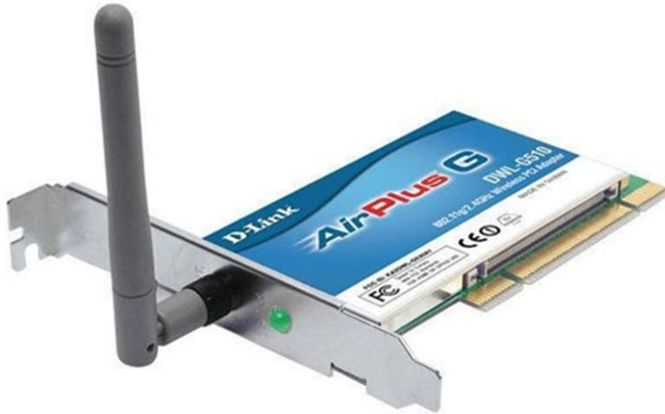
Afbeelding 8: Een draadloze netwerkadapter op een insteekkaart voor een pc
