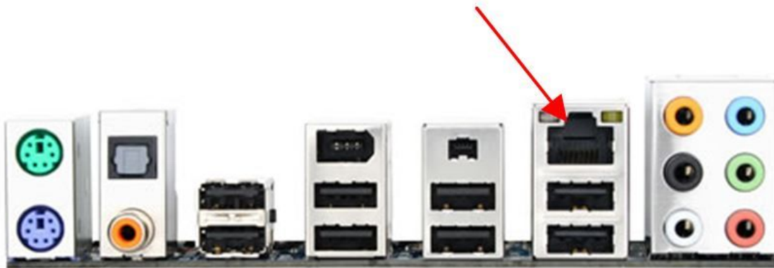
Afbeelding 6: De netwerkaansluiting op een moederbord
